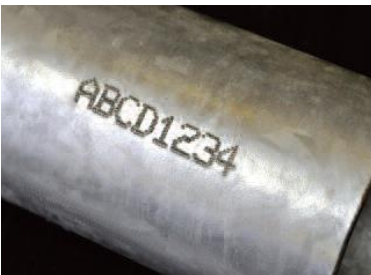
Marcaje de tubos de acero
